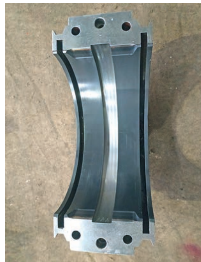
Рис. 10. Опорный подшипник ротора осевого компрессора турбины высокого давления после 6284 ч эксплуатации Fig. 10. Journal bearing of the high-pressure turbine axial compressor rotor after 6284 h of operation
