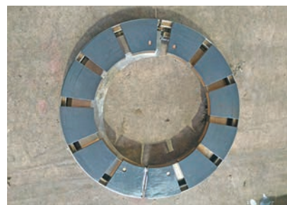
Рис. 7. Колодки опорно-упорного подшипника ротора осевого компрессора турбины высокого давления после 6284 ч эксплуатации Fig. 7. Pads of the journal and thrust bearing of the high-pressure turbine axial compressor rotor after 6284 h of operation
