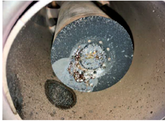
Рис. 6. Обрыв термопары на выхлопе ГТУ
