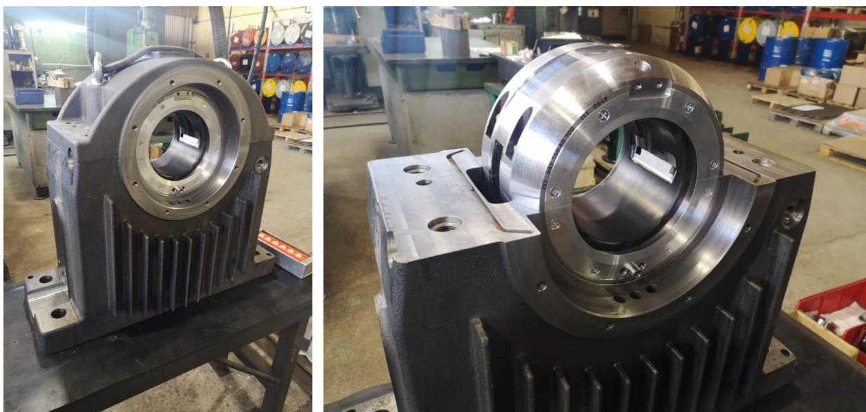
Рис. 11. Необслуживаемый подшипник с картерной системой смазки для электродвигателя СТДМ-5000-2РУХ4 (ООО «Электротяжмаш-привод»)
